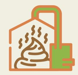
THE ANAEROBIC DIGESTION PROCESS BREAKS DOWN THE ORGANIC MATTER IN THE ABSENCE OF OXYGEN, PRODUCING BIOGAS.
